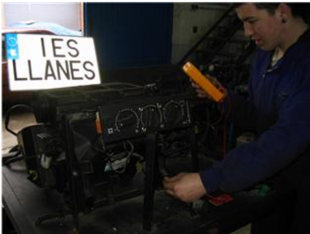
Comprobación de sensor de temperatura.
