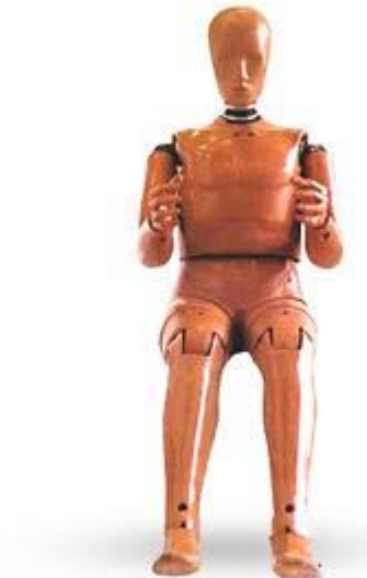
Hybrid III : Diseñado para recoger información de choques frontales
