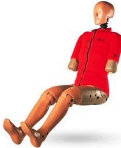
EuroSID II : Diseñado para recoger información de choques laterales
