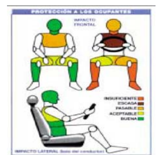
PRESENTACIÓN TÍPICA DE LOS RESULTADOS DE UN ENSAYO DE CRASH-TEST DEL EURONCAP, SOBRE RIESGOS DE LESIÓN DE LOS OCUPANTES
