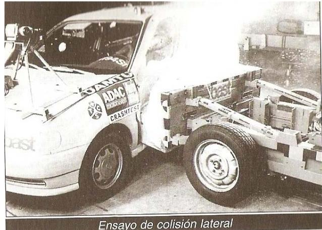
*Ensayo de colisión lateral*
