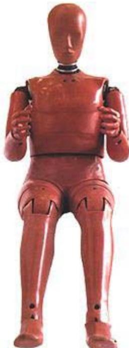
**Cabeza.** Es de aluminio y caucho con acelerómetros para los tres ejes de movimiento, que miden las fuerzas a las que se somete el cerebro en un choque.
