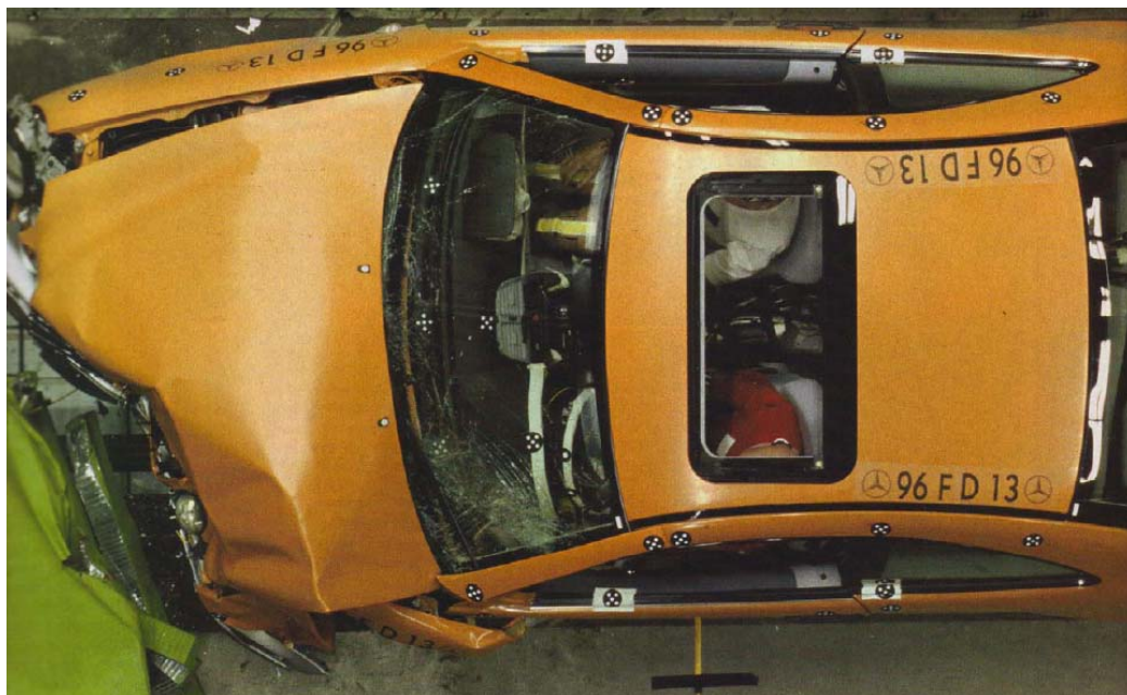
Choque Asimétrico contra Barrera Deformable - ODB - Offset Deformable Barrier
