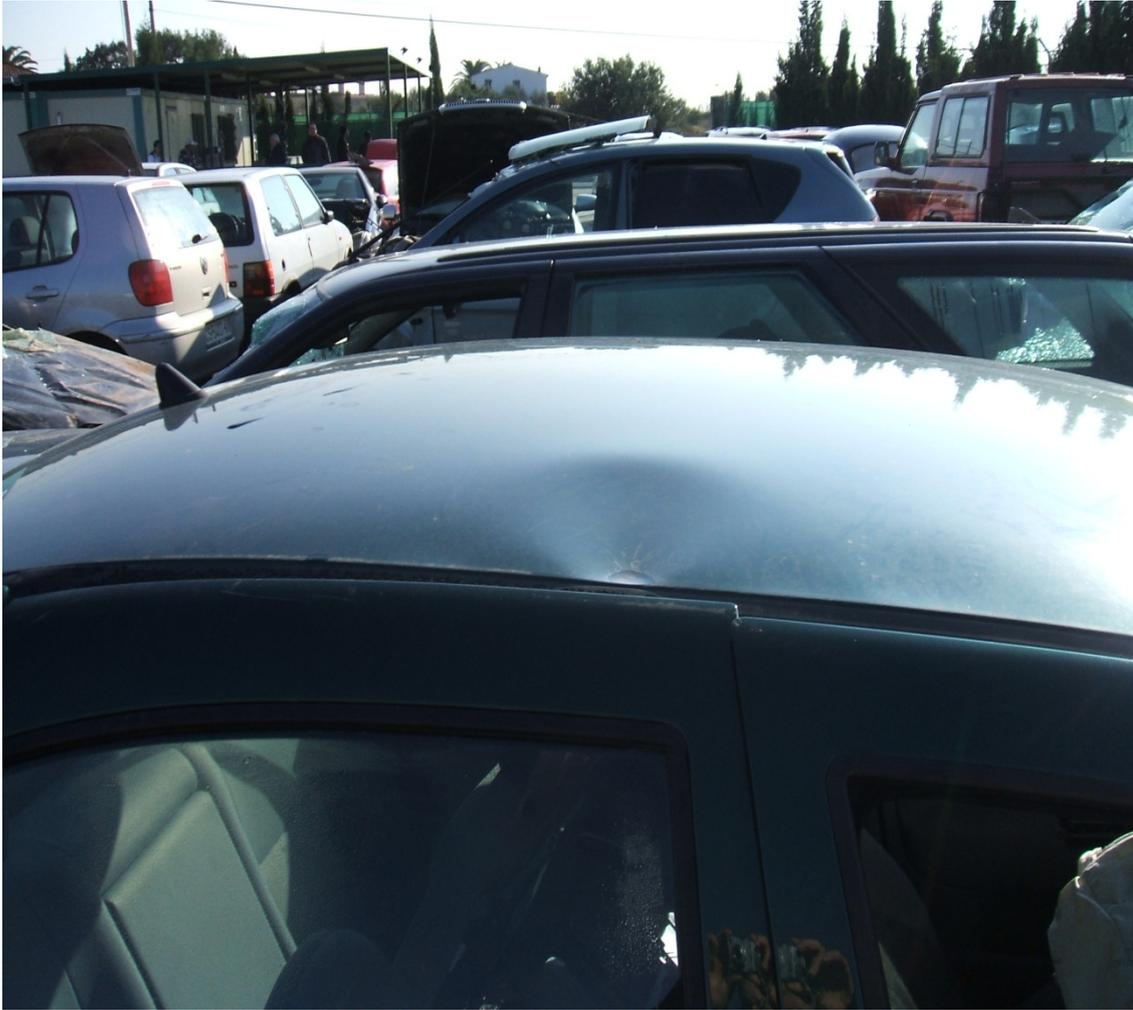
Con todas estas deformaciones procedimos a observar el ajuste de las puertas, pues sospechábamos que este ajuste habría cambiado considerablemente, nos percatamos que el lado izquierdo no había cambiado el ajuste inicial de sus puertas y cerraban las dos correctamente, mientras el lado derecho, como se aprecia en la siguiente fotografía, si que había variado muy considerablemente y por lo tanto ni llegaban a cerrar porque tropezaba la delantera derecha con la trasera izquierda.
