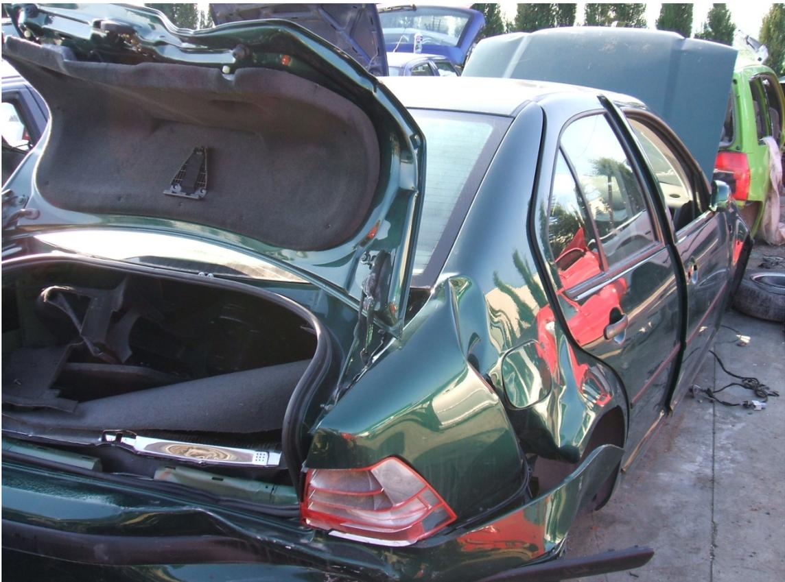
Los otros elementos estructurales afectados visibles fueron: La chapa del techo del vehículo. El estribo trasero derecho (puerta trasera), se apreciaban deformaciones en forma de arrugas. En la siguiente fotografía se aprecia la arruga creada en la colisión en el techo del habitáculo, con también se aprecia en la fotografía, en el lado izquierdo (donde no se ha producido el impacto) está intacta, sin embargo en el lado donde se produjo (el derecho) se aprecia dicha deformación.
