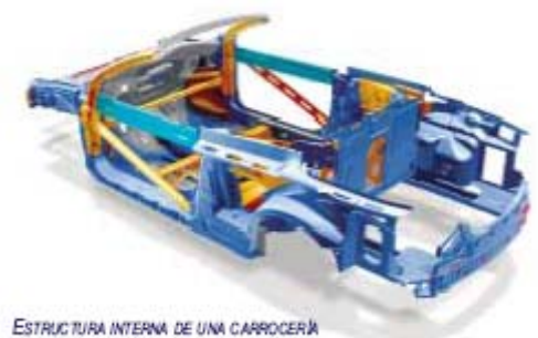
ESTRUCTURA INTERNA DE UNA CARROCERÍA
