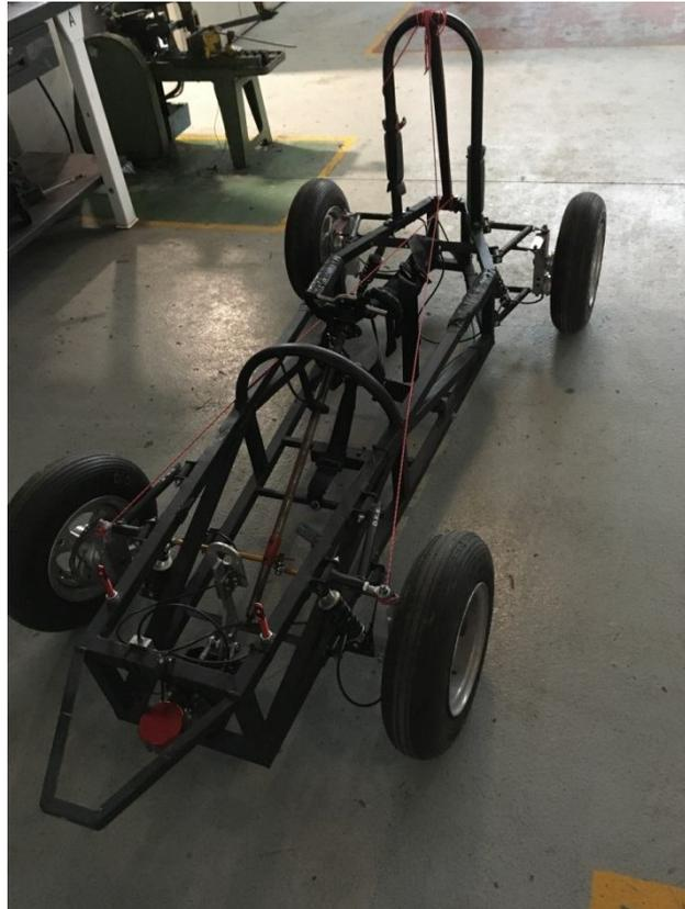
Se puede calcular la geometría de Ackerman prolongando la línea imaginaria que pasa entre el pivote de sujeción de las manguetas y el punto de unión entre el eje de dirección los tirantes de dirección.
