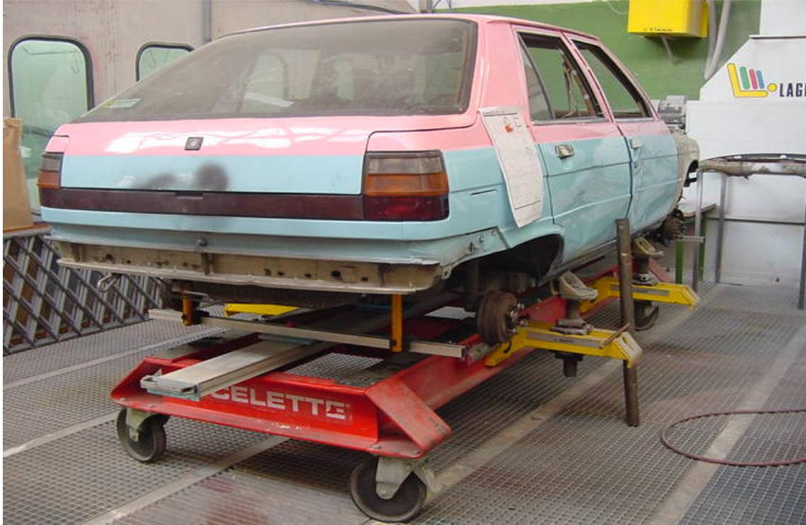
En esta imagen ya habíamos colocado las barras de medida y los correspondientes útiles necesarios para poder medir el vehículo en la parte de atrás.
