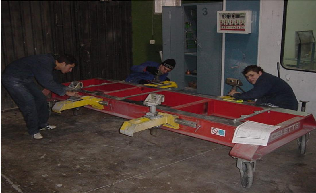
Una vez encontrada la ficha nos pusimos a preajustar las medidas de la bancada que como se puede apreciar es una bancada cellete con el bastidor elevado del suelo pero móvil.
