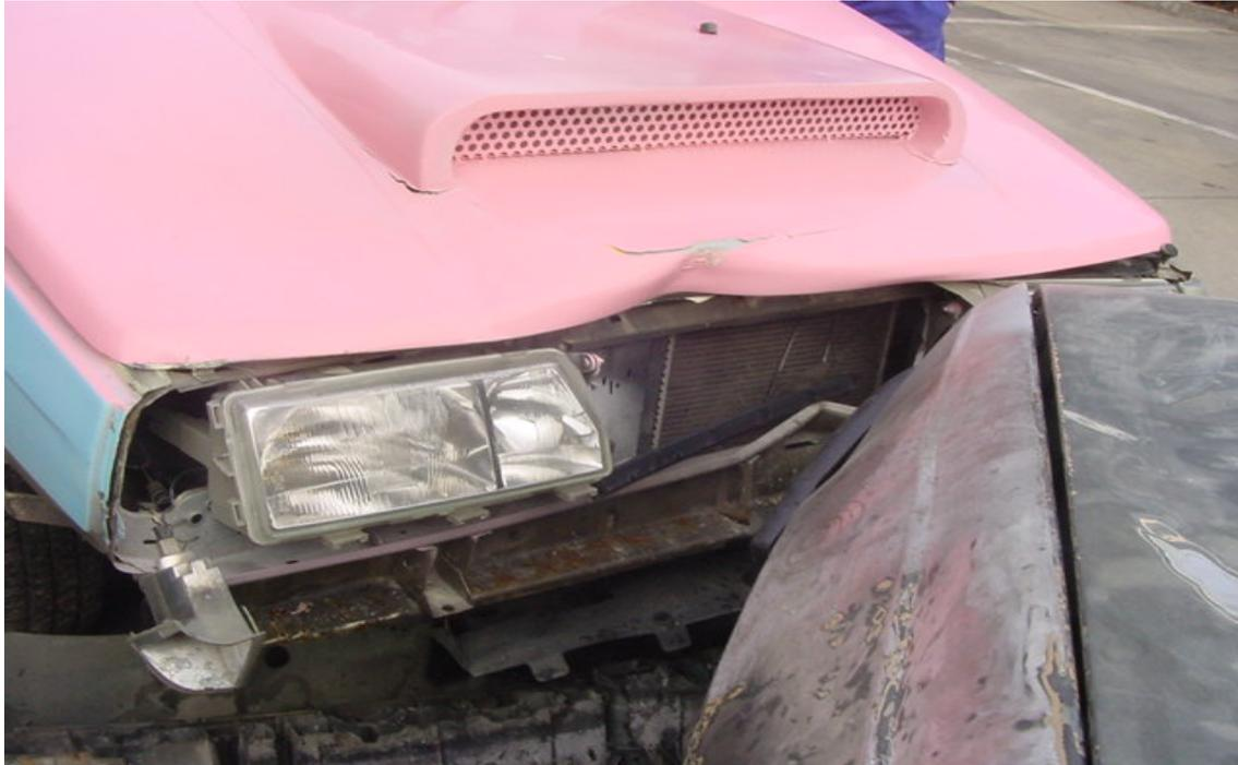
Así quedó el r11 después del golpe. Como se puede apreciar se abolló el capó se rompió la calandra el parachoques se calló y partió y lo mas complicado de arreglar es que también se deformaron las traviesas delanteras, tanto la inferior como la superior.
