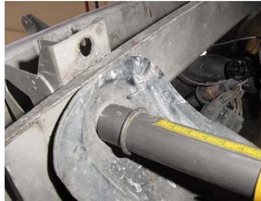
Al igual que en la parte trasera del vehículo en la parte delantera también pusimos los útiles de medida, en la primera foto se ve el lugar donde iba metido el útil y en la segunda ya se puede ver el útil colocado.
