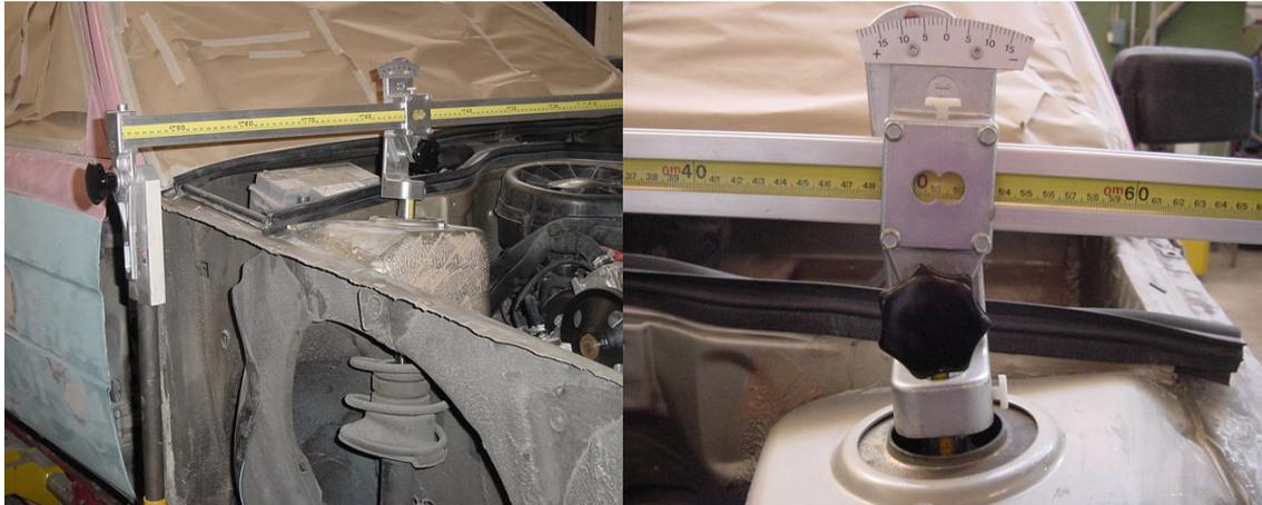
Una vez colocada la regla superior lo que hicimos fue fijar el ángulo longitudinal el ángulo transversal, también fijamos el ancho, montamos los terminales y colocamos los pistones pequeños en la posición más alta. Después lo que hicimos fue poner la barra superior sobre los pistones de las columnas laterales y bajar los pistones pequeños hasta los puntos que teníamos que controlar.
