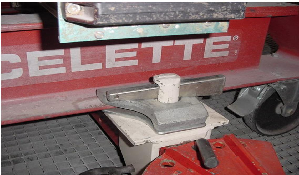
Lo que hicimos a continuación de medir con todos los aparatos fue desmontarlo todo y empezar a montar la “L” de estiraje. En la foto lo que estamos haciendo es apretar las cuñas para sujetar la L al bastidor de la bancada.
