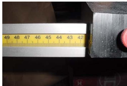
En las imágenes anteriores se ve claramente como ajustamos las pinzas de las reglas de medida exactamente a 41,5, para posteriormente asegurarnos que el coche en la parte trasera no había sufrido ningún tipo de daño.
