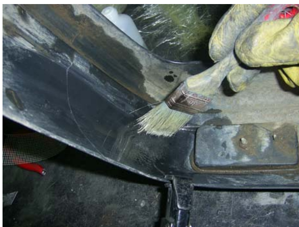
Fig: 8 y 9 Aplicación de resina y 1ª malla de fibra de vidrio.
