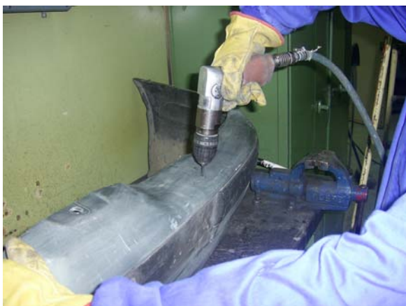
Fig. 1y 2 Taladrado final de grieta y acanalado en V
