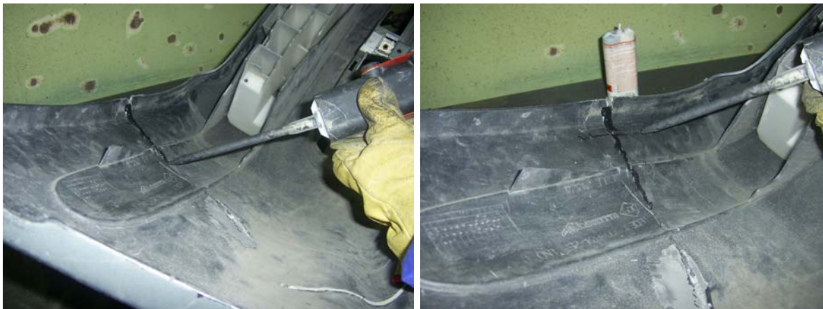
Fig. 6 y 7 Unión con adhesivo de dos componentes.
