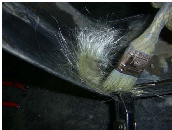
Fig: 10 Aplicación de fibra de vidrio.
