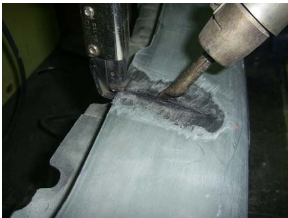
Fig. 4 y 5 Soldadura con aire y con varilla de aportación
