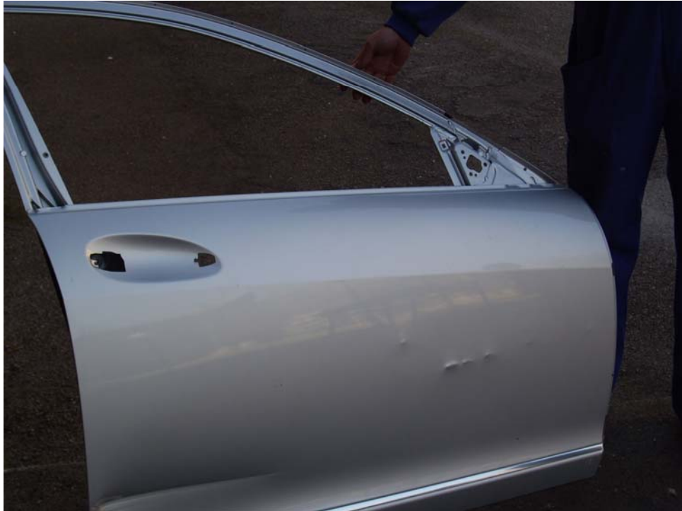
Puerta Delantera derecha de Aluminio del Mercedes S 500 de 1,2 mm. de espesor
