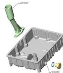
asegurar que la toma de aspiración de la bomba esté sumergida en aceite en cualquier situación de funcionamiento del vehículo. El cárter lleva un tapón de vaciado en su parte más baja para facilitar el desalojo del aceite. A partir de una determinada fecha, entrará en vigor una normativa de la C.E.E. que obligará a los fabricantes a eliminar éste tapón por motivos ecológicos, por lo que será necesario el empleo
