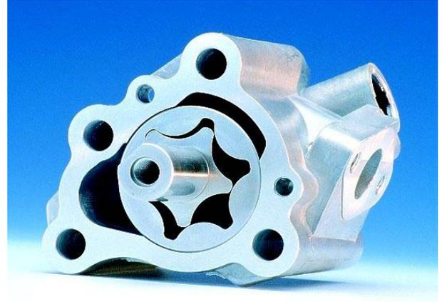
Al girar el rotor arrastra al anillo loco (ambos giran en el mismo sentido), y como aquel tiene un diente menos se forma el hueco creciente, que se llena de aceite (aspiración), y cuando disminuye el hueco, el lubricante es expulsado a presión, de forma parecida a la bomba de engranajes exteriores. La holgura máxima tolerable entre el rotor y el anillo loco es de tres décimas de milímetro.
