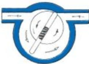
Se compone de un cuerpo de bomba cilíndrico, en cuyo interior se mueve un rotor excéntrico, ranurado diametralmente y arrastrado por el motor según el sentido de la flecha. Esta ranura recibe dos paletas deslizantes, siempre tendiendo a separarse por la acción del resorte que las cié contra las paredes de la bomba. Al girar el rotor excéntrico, la paleta, por su izquierda, va haciendo el vacío aspirando el aceite
