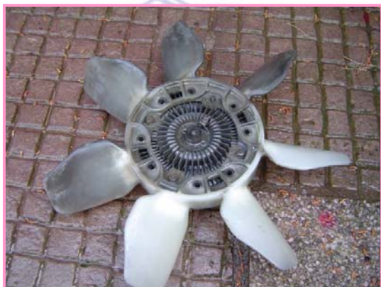
(fig.35 ventilador de acoplamiento viscoso)
