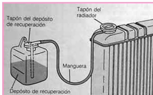
(fig.39 deposito con vaso de expansión incorporado)
