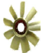
Con el aumento de velocidad se crea un flujo de aire suficiente. Las aspas son curvas en las puntas y con frecuencia se encuentran espaciadas de manera no uniforme para reducir el nivel de ruido.
