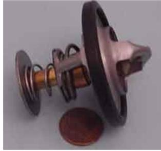
El termostato que se muestra en la fotografía, es típico en varios modelos de Toyota.
