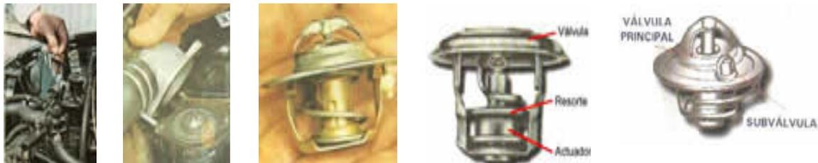
Algunos termostatos funcionan bajo el principio de dilatación de una espiral metálica la cual abre o cierra una válvula en función de la temperatura necesaria para esa dilatación. (Ver figuras a la derecha).
