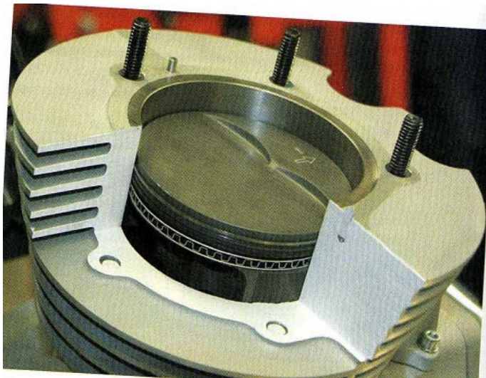
Cilindro refrigerado por aire.
