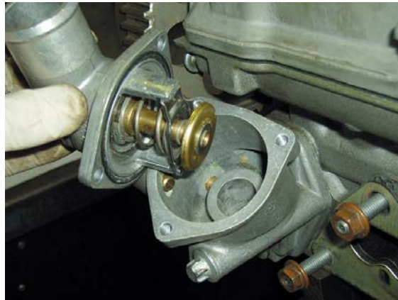
Vista de un termostato y su ubicación.
