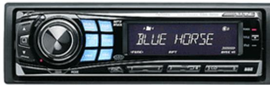
Para tener una buena recepción de la señal de radio es muy importante que, tanto la masa de la carcasa del autorradio como de la antena sean buenas; de lo contrario, los parásitos inundarán la recepción, sobre todo en Onda Media y en emisoras lejanas de Frecuencia Modulada.
