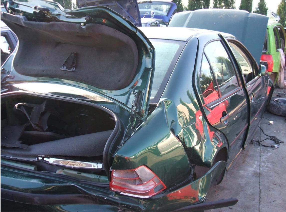
Los otros elementos estructurales afectados visibles fueron: La chapa del techo del vehículo. El estribo trasero derecho (puerta trasera), se apreciaban deformaciones en forma de arrugas. En la siguiente fotografía se aprecia la arruga creada en la colisión en el techo del habitáculo, con también se aprecia en la fotografía, en el lado izquierdo (donde no se ha producido el impacto) esta intacta, sin embargo en el lado donde se produjo (el derecho) se aprecia dicha deformación.
