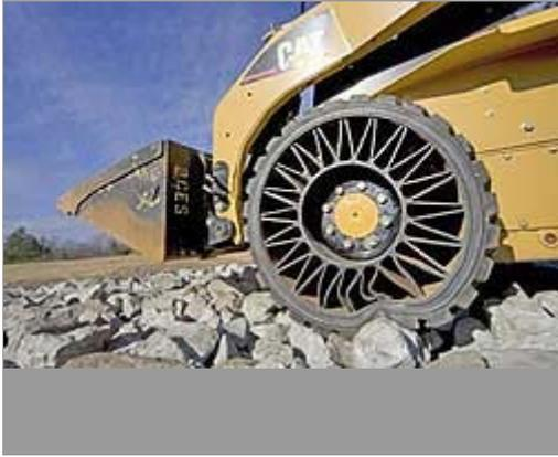
En este caso, la rigidez que da el aire a presión se logra construyendo la carcasa exterior con un material muy duro y, al tiempo flexible. Es un plástico de última generación que, además, lleva una especie de armadura, también de material sintético, que sustituye a
