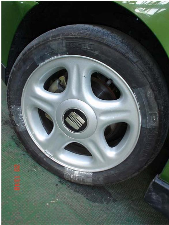
Por esta razón, la llanta de aleación con el borde exterior ancho que se ofrece como llanta de base profunda no merece dicho nombre. Podría denominarse llanta de hombro ancho. Las ruedas de chapa de acero se componen de la llanta propiamente dicha el disco que suele ir soldado a esta, con el que se fijan las llantas al soporte de la rueda.
