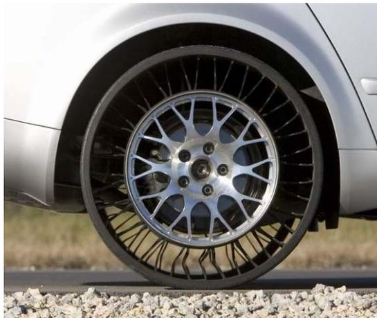
Michelin Tweel, un proyecto revolucionario para sustituir al neumático
