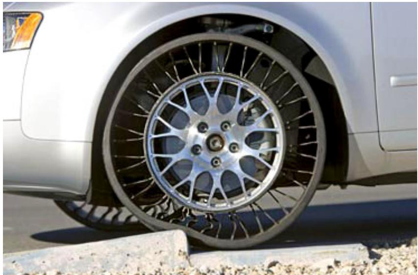
De esta manera, proporciona una gran comodidad porque absorbe las irregularidades del terreno, pero tiene un ángulo de deriva muy pequeño, comparado con una rueda con neumático, a igualdad de fuerza de deriva.
