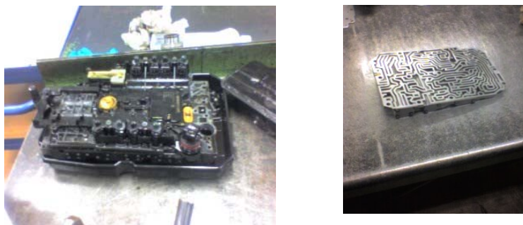
Ilustración 7. Unidad electrónica y calculador o captador capaces de controlar funcionamiento caja robotizada.
