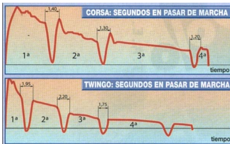
Figura 24. Comparativa entre el Easytronic (gráfica superior) y el Quickshift 5 (gráfica inferior). Aceleración a fondo en modo automático SMT (Toyota)
