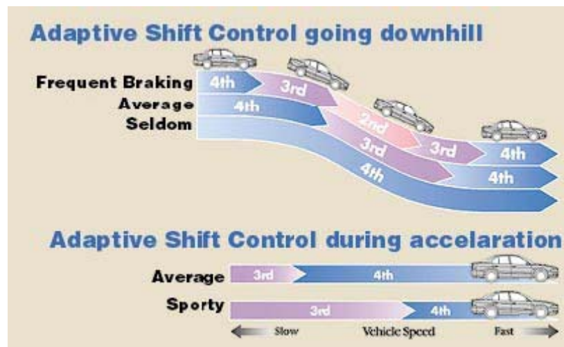
Figura 8. Respuesta del INVECS II ante un descenso y una aceleración
