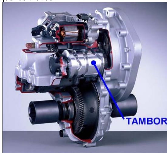
Figura 25. Caja de cambios del Smart
