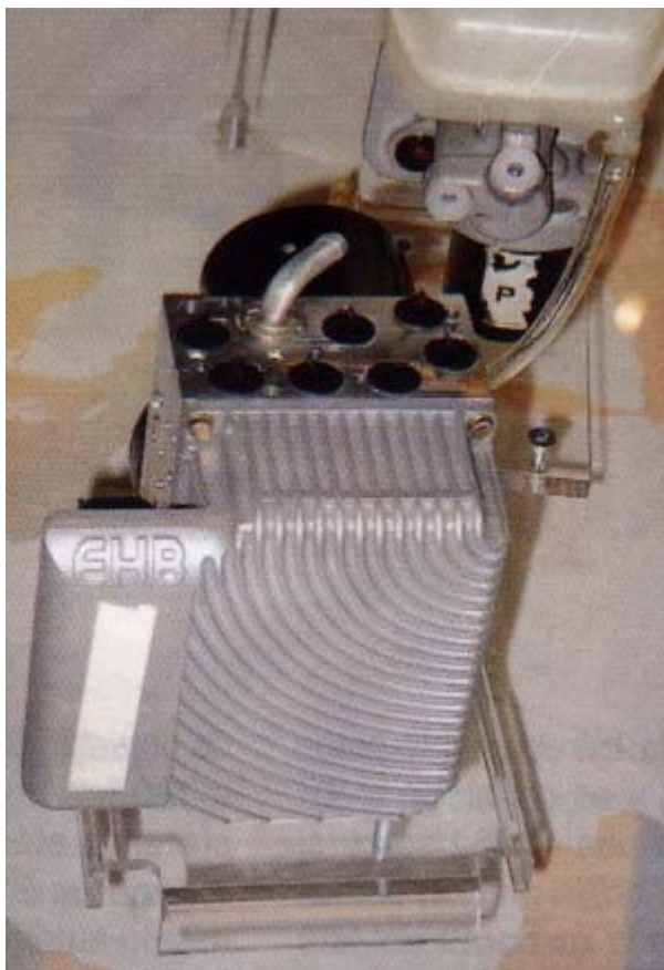
Grupo hidráulico del frenado electro hidráulico.
