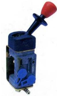
La **Válvula de Freno de mano** está conectada con el circuito de aire comprimido, los pulmones de freno de estacionamiento y una salida a la atmósfera y la cual permite controlar, una frenada progresiva o la parada total del vehículo. Puede ser usada como válvula de freno de estacionamiento, freno independiente, o ambos en conjunto.
