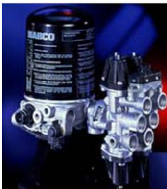
Se denomina **Unidad de Procesamiento de Aire (APU)** a una unidad compuesta por secador de aire con regulador de presión que puede llevar calentador o no, válvula de protección, una conexión para inflador de neumáticos y una válvula de protección de circuito múltiple con o sin limitadores de presión integrados, todos ellos en un mismo bloque.
