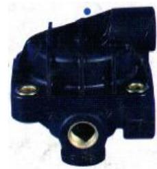
Para independizar las partes del sistema neumático del vehículo unas de otras se usa la **Válvula de rebose**. Impide el paso de aire hacia la utilización hasta que no se alcanza la presión de tarado de la válvula. Existen tres versiones:
