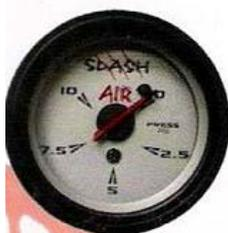
En todo momento **los Manómetros**, situados en la cabina, informan al conductor de la presión de alimentación o de la presión de freno.
