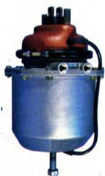
Con el fin de disminuir el número de elementos los **Actuadores de freno (tristop)** constan de dos cámaras independientes dotándole de dos funciones, por un lado la de freno de servicio a través de la cámara de membrana y las de freno de emergencia y estacionamiento mediante la cámara de muelle.
