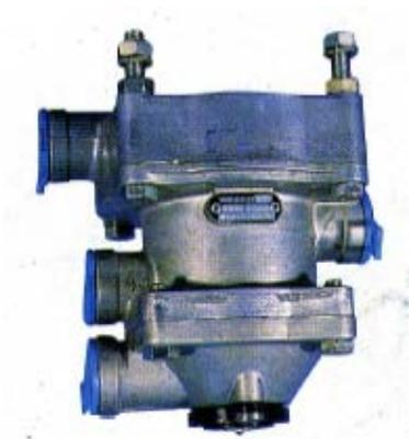
La **Válvula control de remolque**: Controla de forma progresiva la frenada del remolque, aún en caso de avería en cualquiera de los circuitos del freno de servicio o en la tubería de mando del remolque posee un mecanismo regulable de adelanto de presión entre camión y remolque.
