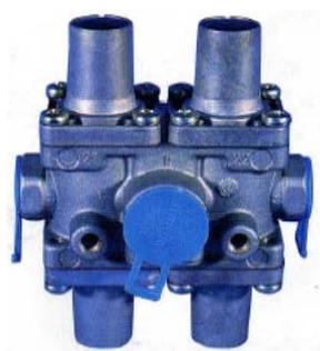
Uno de los componentes más importantes es la **Válvula cuádruple de protección de circuito**. Esta distribuye la presión de alimentación a las distintas líneas que forman el sistema neumático, además garantiza la presión en caso de avería de cualquiera de las líneas que componen el esquema, desconectando automáticamente el circuito dañado y manteniendo la presión a los demás.
