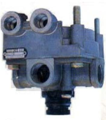
**La Válvula de protección diferencial** impide la superposición de esfuerzos de frenado de servicio y del freno de estacionamiento. Protege los elementos de transmisión mecánica contra sobrecargas.
