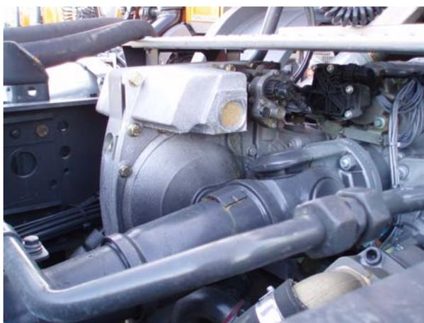
El funcionamiento del sistema consiste en que al accionar el freno permanente, se lleva una determinada cantidad de aceite a la cámara de trabajo de forma rápida. El aceite es puesto en circulación por el movimiento de giro del rotor y este circula en un circuito cerrado entre rotor y estator.
