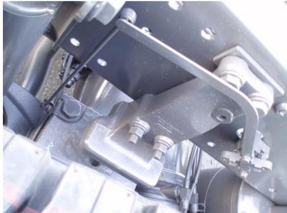
un eje en función de la carga que soporta éste, previniendo así el bloqueo de las ruedas. Hoy en día son sustituidas por potenciómetros que proporcionan a la centralita un valor de la carga del vehículo y ajusta automáticamente la fuerza de frenado.
