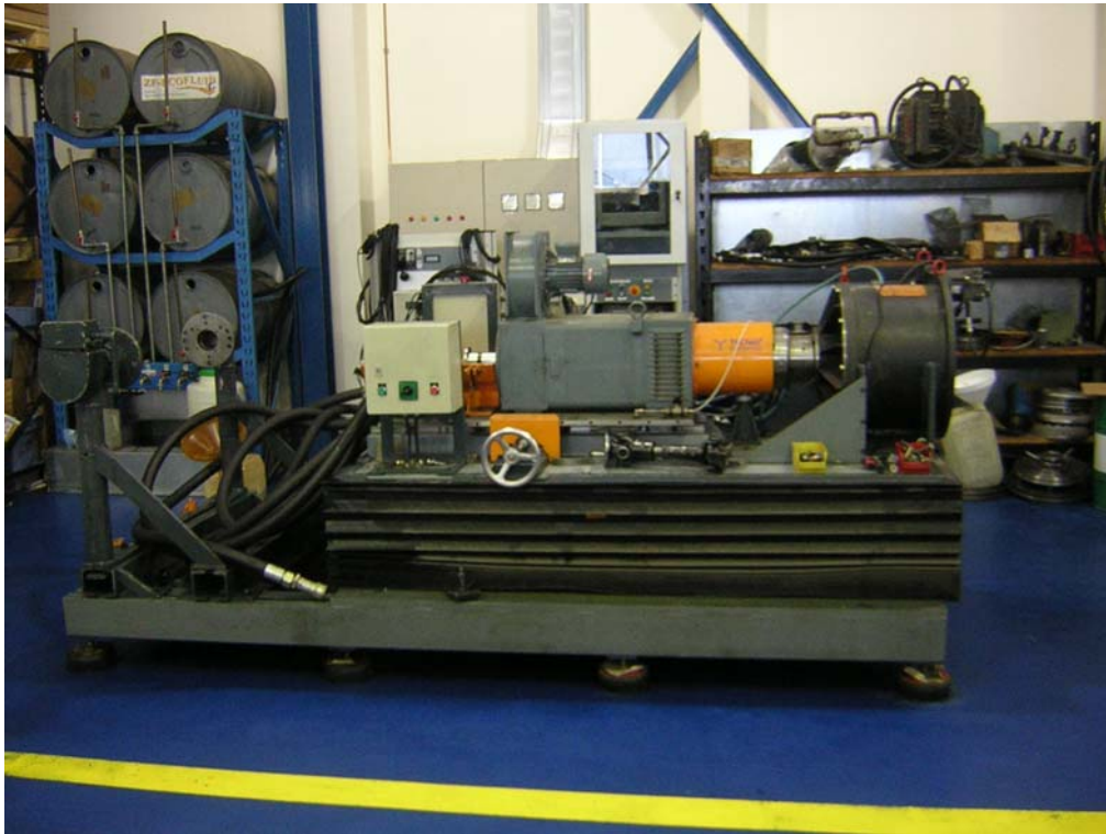
Banco de pruebas cajas de cambio robotizadas
