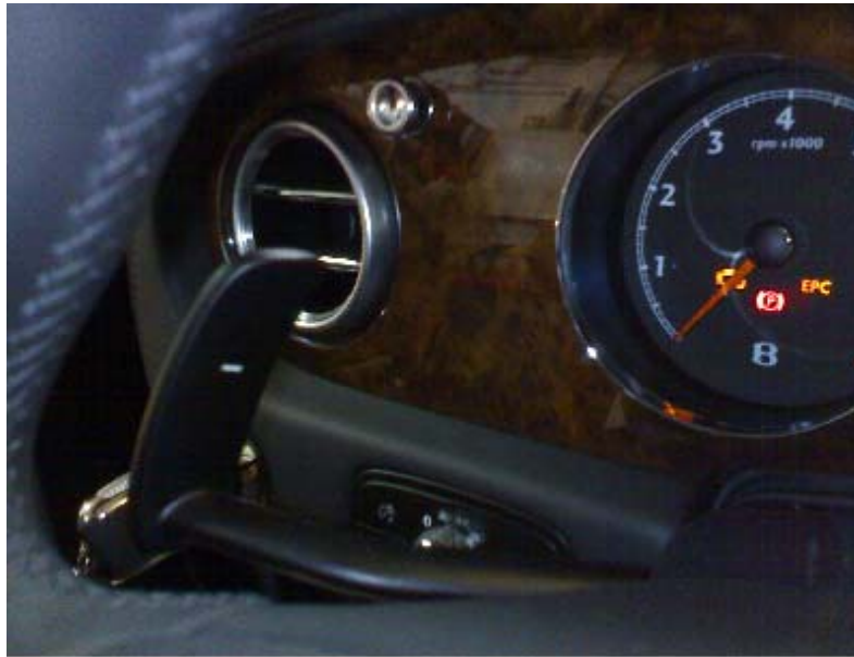
Leva accionamiento secuencial de marcha inferior
