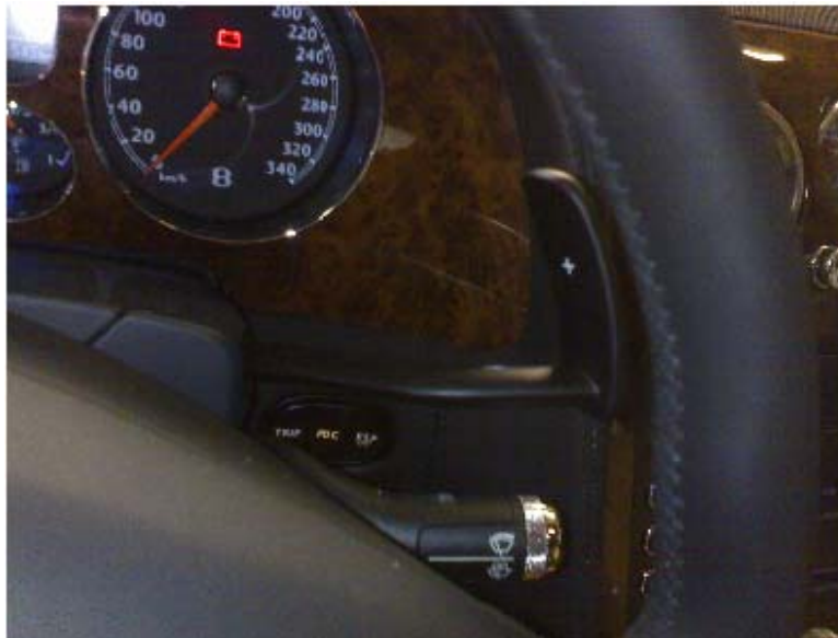
Leva accionamiento secuencial de marcha superior
