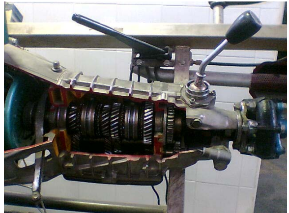
Engranajes Helicoidales
