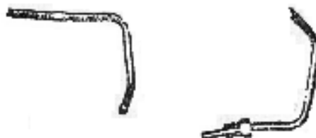
Tubo de acero para frenos el cual presenta dobleces especiales.
