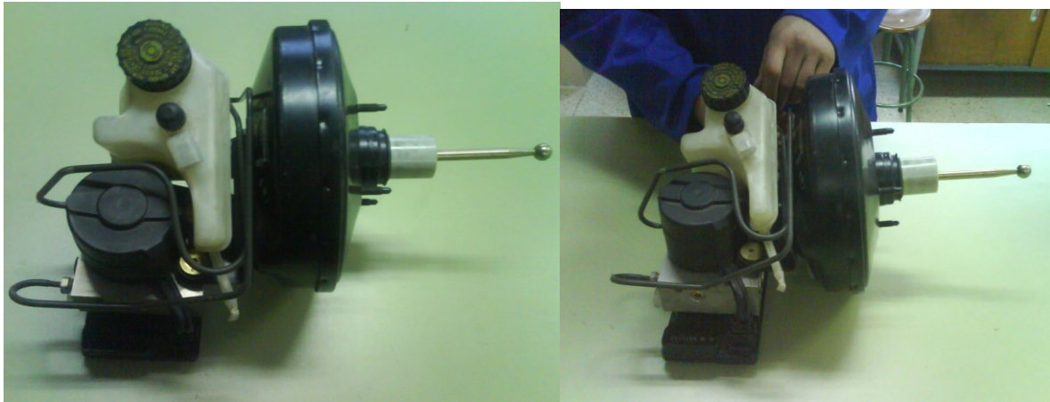
b)IMAGEN DE SISTEMA A.B.S. segunda generación con servofreno para ayuda a la frenada y cuatro salidas.
