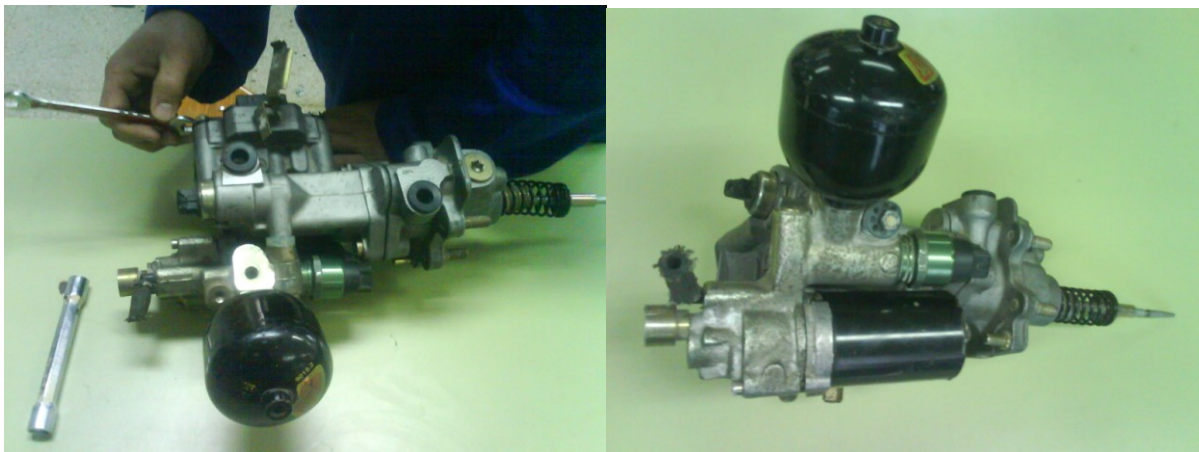
a)IMAGEN DE SISTEMA A.B.S primera generación de 3 vías con acumulador y bomba de presión.
