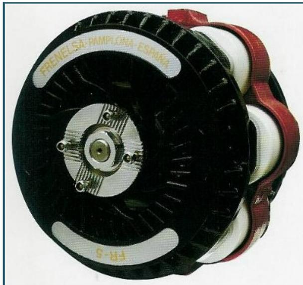
Este sistema de freno se utiliza en vehículos pesados y sólo funciona cuando el motor está en marcha, para frenar en largas pendientes y descargar el sistema de freno principal, evitando su sobrecarga por un uso continuado.
