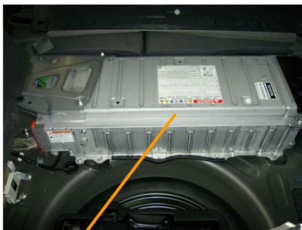
Conjunto de baterías HV
