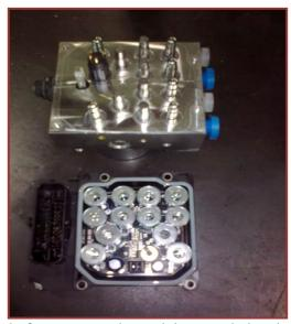
hidráulica sigue en funcionamiento aspirando liquido de frenos procedente del acumulador de baja presión y lo envía al circuito de frenos para así obtener una buena presión, con este aumento de presión la rueda frena nuevamente.
