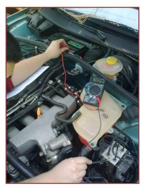
Medimos la resistencia de los captadores de rueda de esta forma comprobamos que el cable no este cortado o haya algún otro tipo de problema, si hay continuidad nos debe dar un valor óhmico en el polímetro.
