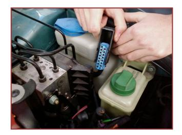
De tal forma que al pinchar con el polímetro en los pins correspondientes nos daba unos valores óhmicos determinados. De esta manera sencilla y fácil de realizar hemos comprobado los captadores y las electroválvulas.
