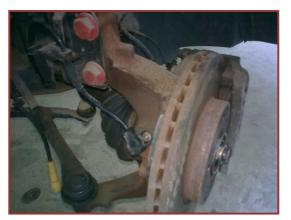
Para ello quitamos la rueda, de esta manera se quedaba el sensor de régimen visible con lo que pinchando en el cable con el polímetro te debe dar un valor óhmico, si no es así es por que el cable esta cortado. La resistencia de las electroválvulas debe estar entre  $0.8 \ y \ 1.8 \ \Omega$ .
