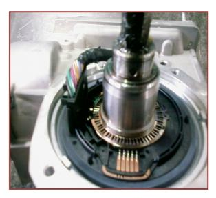
En su primera medición, informa al modulo del ABS/ESP de las diferencias angulares del volante. El módulo mediante unos cálculos, averigua la posición de marcha en línea recta de la dirección con la ayuda de otros sensores del vehículo.
