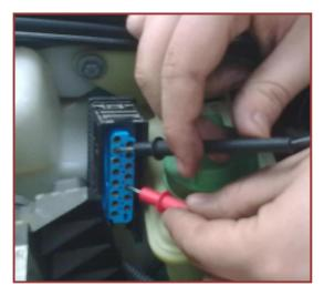
Otra de las pruebas que hemos efectuado sobre el hidrogrupo a sido la de comprobar su masa haber si era correcta para ello hemos utilizado el polímetro en la opción de voltios, a continuación hemos pinchado con la punta roja del polímetro en el borne positivo de la batería y con el negativo por la carcasa del hidrogrupo, una vez echo esto miraremos el display del polímetro y comprobaremos que efectivamente la tensión indicada sea la de la batería de no ser así el hidrogrupo no tendría masa.
