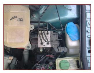
Cuando el conductor aprieta el freno se genera por medio del cilindro maestro una presión, a su vez esta pasa hacia el freno de la rueda mediante una válvula que se encuentra abierta pero la válvula de salida se encuentra cerrada, la rueda va bajando de revoluciones conforme el conductor va frenando, esta información la está procesando la unidad de control mediante los sensores de régimen que manda la señal cuando la rueda empieza a bloquear.
