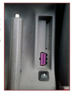
Una ves localizado conectaremos la maquina al conector del vehículo y al propio de la KTS. Una vez conectada la maquina esperaremos a que termine el proceso de carga e inicialización, a continuación introduciremos todos los datos: modelo, marca, año, motorización, combustible utilizado.
