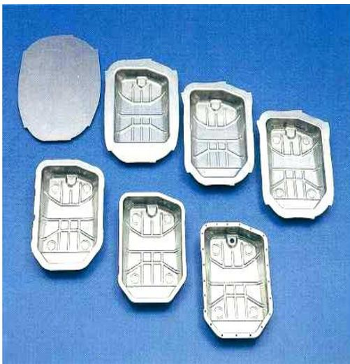
El número de fases o de etapas de embutición depende de la relación que exista entre la magnitud del disco y de las dimensiones de la pieza embutida, de la facilidad de embutición del material y del espesor de la chapa. Cuando más profundidad haya de darse a la pieza a embutir, tanto más etapas serán necesario para la embutición y con ello tanto más herramientas y operaciones. Por ello es necesario prever la forma de realizar siempre operaciones con el menor número de etapas o de piezas simple.
