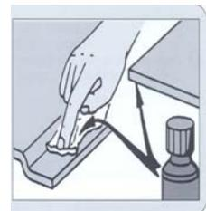
1.5. Aplicación del adhesivo (resinas epoxi o poliuretanos). En este caso, mediante un cartucho provisto de boquilla mezcladora.
