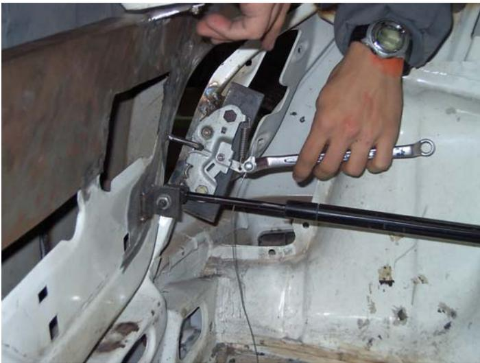
Fig. 8. Montaje de portón por amortiguador hidráulico.
