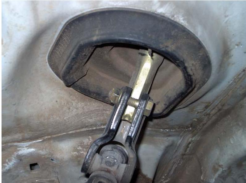
Fig. 2. Unión por tornillo – tuerca en caña de dirección.
