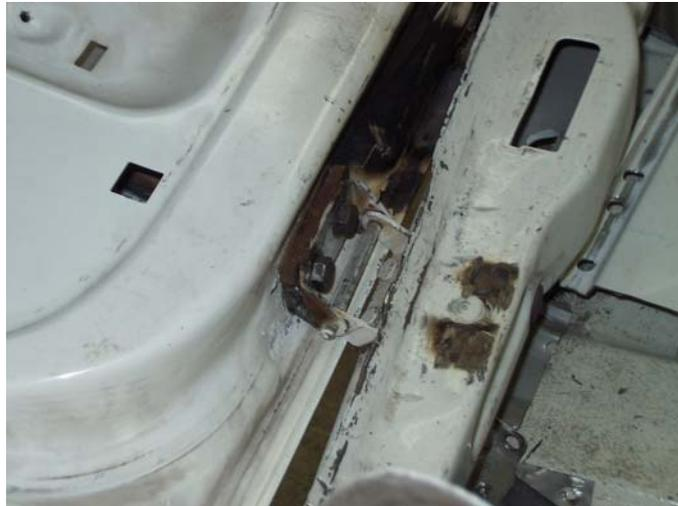
Fig. 3 y 4. Unión agujero roscado y tornillo en bisagra de portón.
