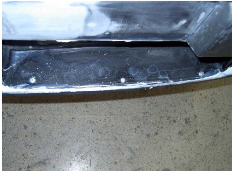
Fig. 10. Unión de faldón al paragolpes por medio de remaches.
