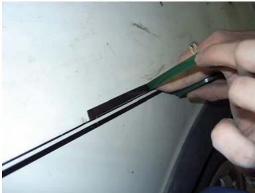
Fig. 14. Fijación por cinta doble cara.
