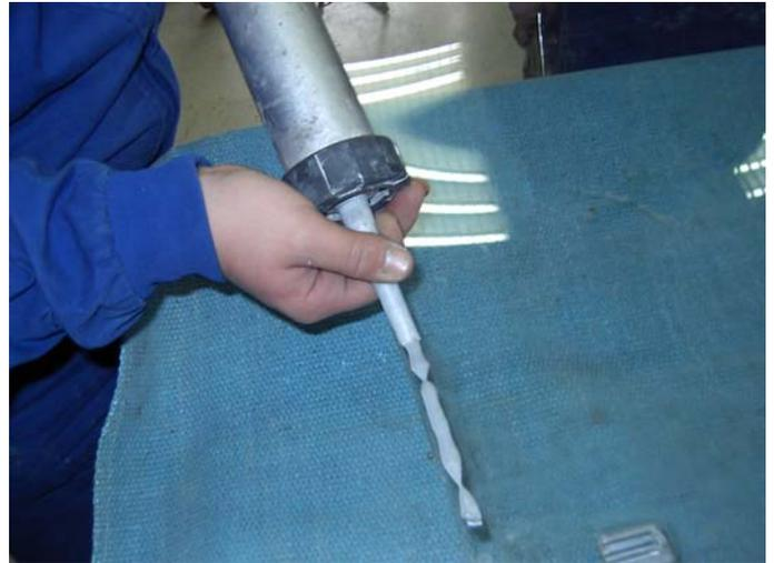
Fig. 15 y 16. Aplicación de activador y polímero para el pegado de lunas.
