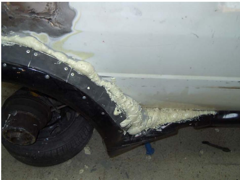
Fig. 17 y 18. Unión con espuma de Poliuretano.
