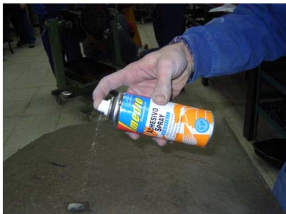
Fig. 11. Aplicación de adhesivo en spray en tapizado.
