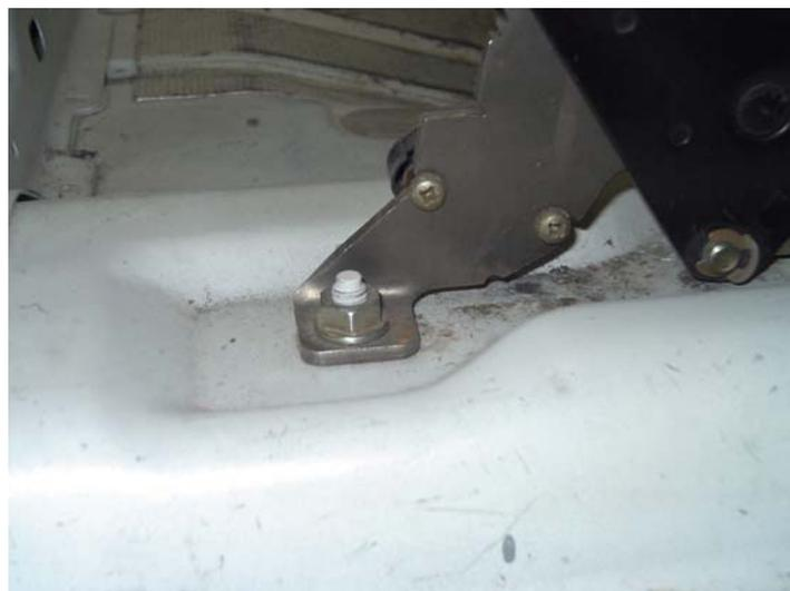
Fig. 5. Unión por espárrago en freno de mano.
