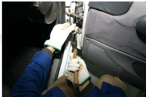
El pasador se extrae mediante un votador y un martillo, o la utilización de utillajes especiales.
