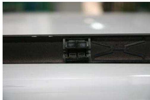
Guardafangos: este va acoplado al paso de rueda mediante grapas de plástico.
