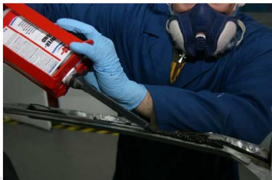
4.- Una vez aplicado el cordón de adhesivo estructural, se coloca el techo. Una vez colocado en la posición adecuada se colocan las mordazas de presión en los lugares de fácil acceso, y con ayuda de las ventosas y la cincha se logra ejercer una presión controlada sobre las zonas de difícil acceso. Para finalizar esta unión y asegurar su estanqueidad se aplicará un cordón de sellador uniformemente sobre la junta de la pestaña del techo.
