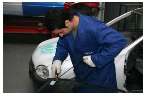
2.- Para finalizar las operaciones de limpieza, pasamos un papel con disolvente a la superficie de contacto del cordón y tras ello aplicamos la imprimación sobre las superficies a unir.
