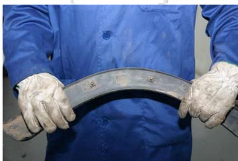
Las uniones presentadas a continuación corresponden a la moldura del techo, esta va colocada en la pestaña del vierteaguas.
