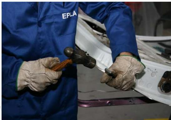
3.- Tras haber extraído el panel de puerta y eliminar los restos del engatillado anterior con el clean & streap, procedemos a la aplicación del adhesivo.
