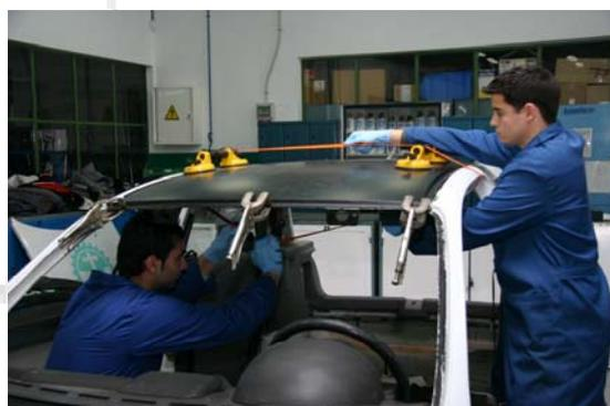
➤ Procedimiento de sustitución de la luna delantera.
