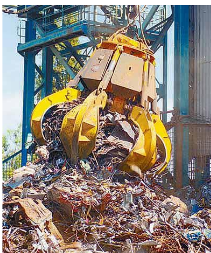
FIGURA 8.2: UN PULPO COGIENDO RESIDUOS DE METAL PARA SER PRENSADOS
