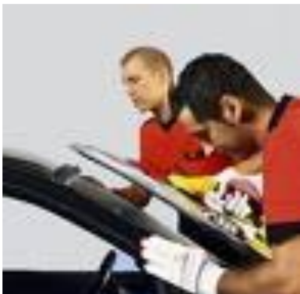
FIGURA 8.1.3: DOS OPERARIOS EXTRAYENDO LA LUNA DELANTERA DE UN VEHÍCULO PARA SER RECICLADA
