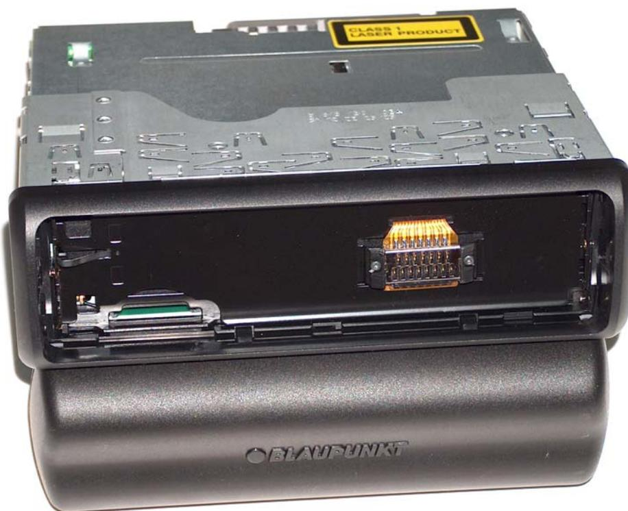
Ahora ya tenemos buena parte del trabajo realizado. Procederemos, a conectar el ISO a la fuente, con lo que ya puede sonar. No sin antes verificar en este apartado si la fuente se conecta -se ilumina la pantalla-. Si no es así, hay que verificar las conexiones. Si éstas están correctas, verifica la caja de fusibles, no sea que mientras instalabas el conector, se haya producido un cruce.
