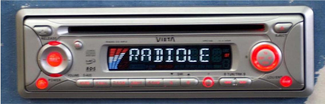
Una fuente de sonido consta de: un lector (CD, cassette, minidisc, mp3, etc.), un sintonizador de radio y, opcionalmente, un C.I. (Circuito Integrado) amplificador. Este último no existe en las fuentes de alto nivel, ya que éstas se emplean como “fuentes puras” y los C.I. sólo “estorban” en estos casos.
