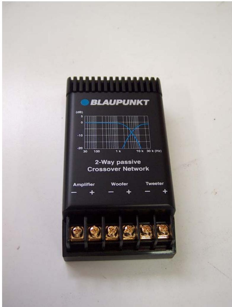
Un filtro permite que se transmiten 1 ó más bandas de frecuencia mientras rechaza las señales que no se hallen en dichas bandas.
