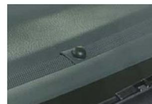
unidad de control actúa sobre la trampilla de mezcla y la velocidad del soplador. Puede ser de tipo resistencia variable (LDR) o fotoeléctrica de tensión variable.
