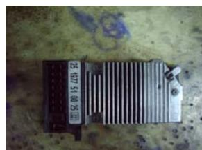
Esta centralita es la encargada de accionar la turbina y la bomba del calefactor y a su vez de parar dichos elementos cuando recibe la orden de la centralita del interior del habitáculo o de los diferentes sensores de temperatura integrados en el calefactor.
