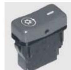
*Pulsador del climatizador:* Es el encargado de poner el sistema en funcionamiento con el vehículo en marcha o parado.
