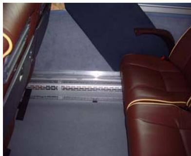
Éstos conducen por su interior líquido refrigerante procedente del motor de combustión o de la bomba de calor adicional.
