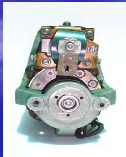
Motor de arranque con inducido deslizante
