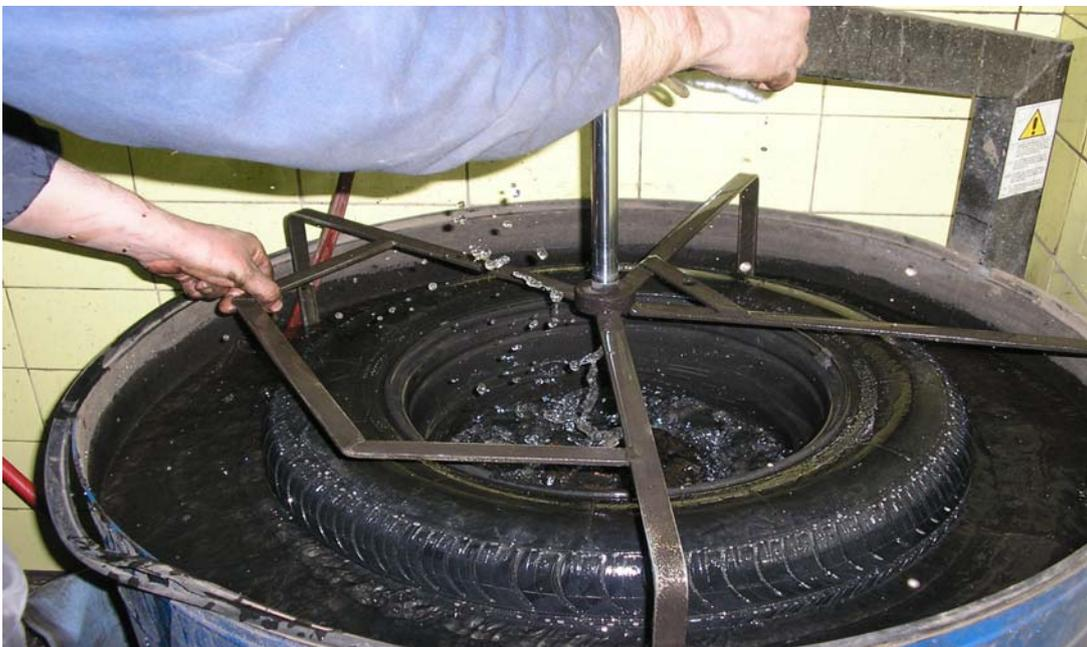
El neumático se desmonta con una máquina que mediante unas palancas despega los talones de la misma, una vez despegados se extrae el neumático con un desmontador y con la ayuda de la máquina.
