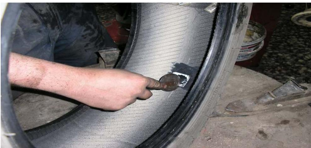
Una vez terminado de arreglar el pinchazo se le mete una cierta presión de aire se vuelve a meter en la máquina del agua para comprobar que ha quedado bien arreglado y no pierde aire la rueda , si la rueda una vez comprobada no pierde aire se vuelve a montar sobre el vehículo.
