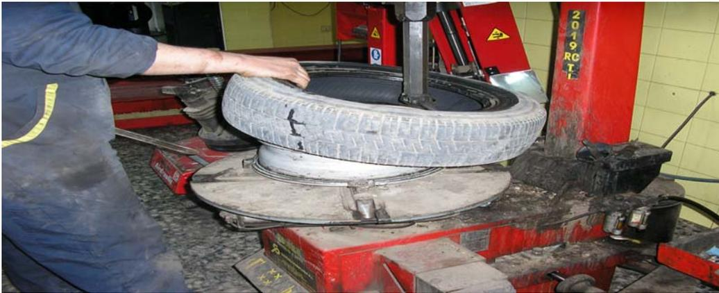
Sacado ya el neumático se le aplica solución al pinchazo, se le pone un parche y mediante un rodillo hace que quede bien pegado por todos los lados, (hay que esperar un par de minutos para que la solución quede bien pegado al parche.
