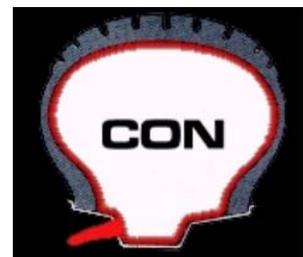
provista de una válvula, mediante la cual se le suministra el aire necesario para que la cubierta o neumático tenga la presión suficiente.
