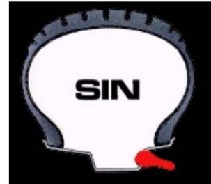
una llanta adecuada para su montaje (con garganta en forma de V y válvula incorporada), aunque un aspecto exterior es idéntico al de un neumático tradicional con cámara. La principal ventaja es la gran resistencia a la pérdida de
