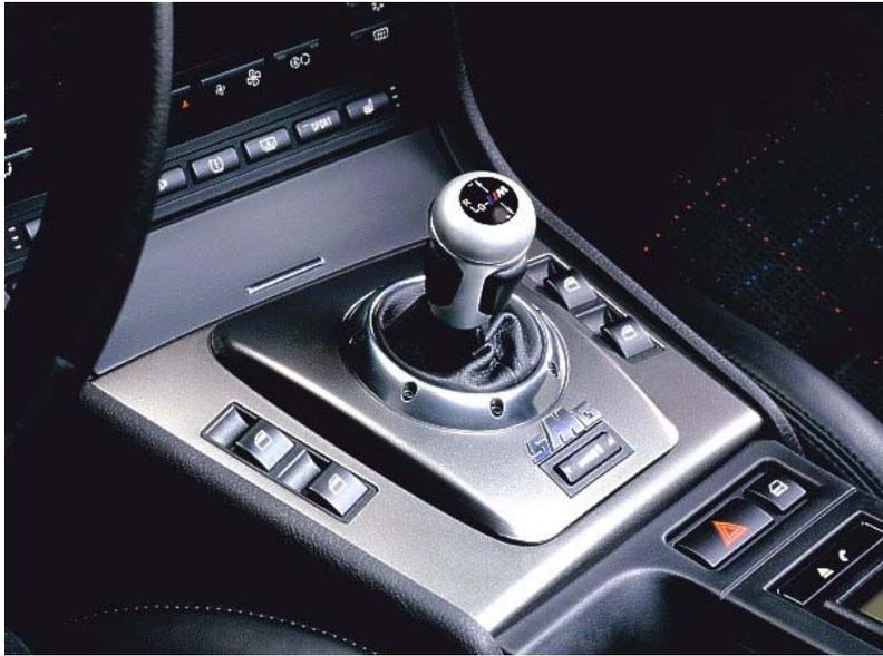
En el modo S, con el sistema Drivelogic el conductor adapta manualmente la dinámica de los cambios de marcha, eligiendo su preferido entre seis programas, que comienzan con el S1 que permite una conducción dinámica reposada, arrancando suavemente en segunda y
