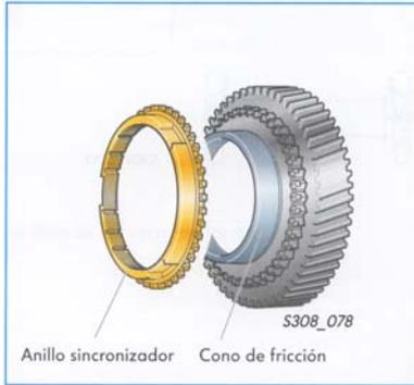
El rendimiento de la sincronización aumenta a raíz de ello, por estar disponible una mayor superficie para la transmisión del calor que resulta del trabajo de sincronización.
