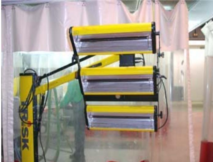
Los tiempos de secado se reducen considerablemente respecto del sistema convencional de secado en cabina-horno, según el tipo de pintura, tipo de IR utilizado, e incluso del color.
