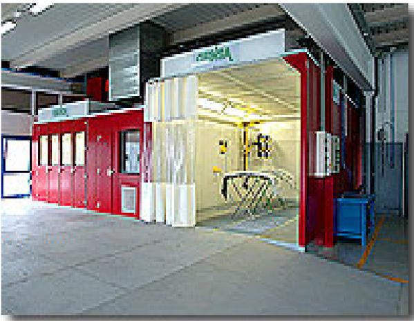
El espacio y el diseño tiene gran importancia, así como la salida de gases al exterior, de forma que se asegure la ausencia de turbulencias y de sobrepresiones. Además, el plano aspirante debe tener un acabado que garantice inalteradas las características de funcionamiento a lo largo de su vida 10/15 años ó 15/20.000 horas de trabajo.
