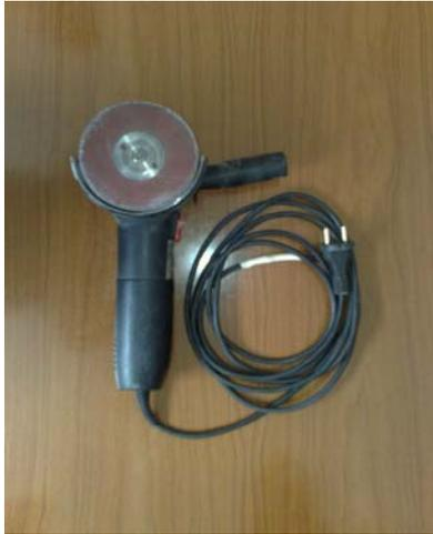
Estas máquinas giran sobre un punto fijo, lo que impide el lijado plano de la superficie. Están indicadas para trabajos de desbarbado de metal, eliminación de puntos de soldadura, limpieza de la corrosión y el corte de paneles de puerta para su extracción.
