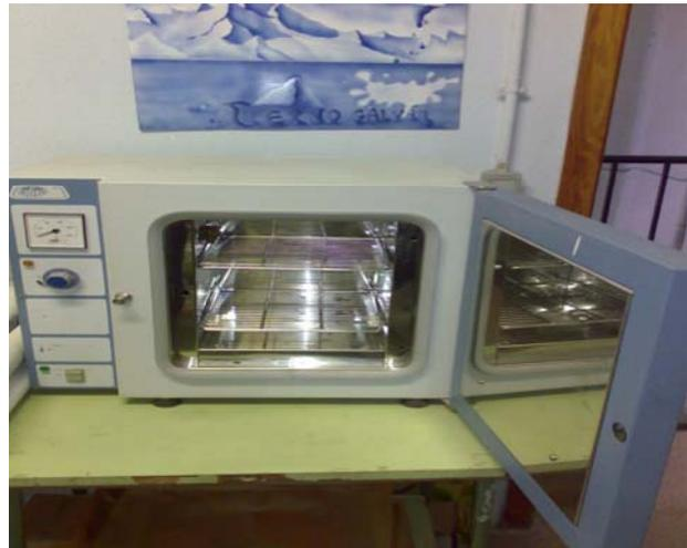
probeta, que cosiste en un pequeño horno, donde se introduce la probeta, que eleva su temperatura utilizando una resistencia eléctrica y un ventilador que hace circular el aire a través de la resistencia, igual que en las cabinas de horno por convención. La temperatura esta controlada por un termostato que limita la temperatura programada (entre 50 °C y 180°C) por el operario y por un temporizador que regula el tiempo de secado, tal y como ocurre en las cabinas de pintura de vehículos.
