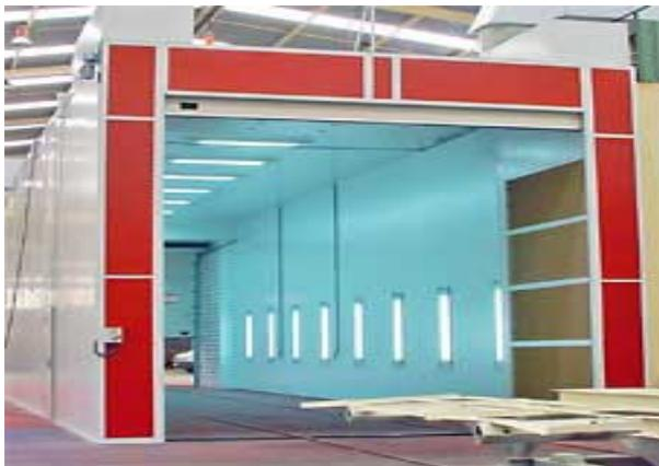
de un determinado número de horas de funcionamiento de la cabina, ya que se van cargando, dificultando la circulación de aire en la cabina y creando una sobrepresión excesiva que perjudica tanto al pintado (se crean turbulencias interiores) como al operario, al trabajar en un ambiente poco saludable que le puede producir cansancio.
