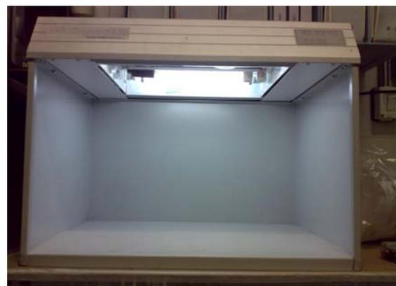
Para realizar la comparación entre las probetas, se introducirán dentro de la cabina y se verificarán aplicándoles distintas fuentes luminosas, para comprobar si existen problemas de metamerismo.
