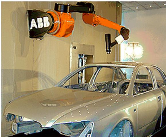
A finales de los años 80 el mundo se deslumbra con los novedosos sistemas robot en los que ya no existe la presencia de las personas, estos robots son manipulados por potentes programas informáticos, siendo estos autosuficientes para cambiar el tipo de pintura (monocapa o bicapa), el color en centésimas de segundos etc.
