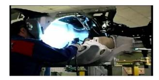
Finalizado el proceso de soldeo, se procederá de nuevo a la verificación de la medida de la pieza sustituida y la comparación con el equipo de medida.
