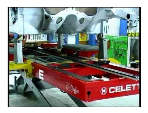
Una vez preparadas procederemos a enfrentar la pieza a sustituir, la cual sujetaremos por medio de unos soportes a la bancada y con la ayuda del brazo de medida la posicionaremos con respecto a la carrocería.
