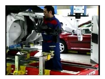
Si realizando los pasos anteriores, no se consigue que todos los puntos los dejemos según las especificaciones del fabricante, tendremos que verificar los que se encuentren dentro de cotas consultaremos el manual del fabricante para determinar si la pieza a reparar se puede hacer una sustitución parcial o total.
