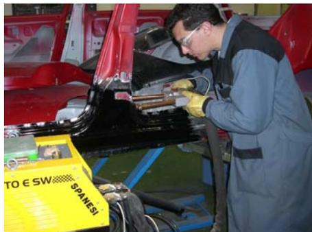
28) Realizar soldadura a tope de las piezas mediante punteado con soldadura MIG MAG para evitar sobrecalentamiento de las chapas.
