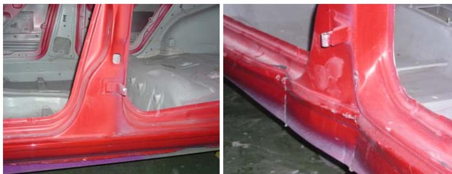
Daño grave con abolladura directa por colisión contra un objeto contundente de grandes dimensiones que ha provocado el hundimiento del estribo en la zona central del lado izquierdo del vehículo desplazando también hacia el interior el montante central de las puertas y con retorcimiento del mismo.
