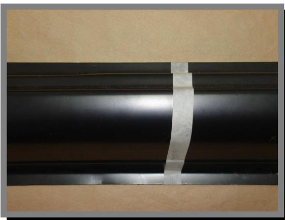
19. Pasar la cota sobre el recambio nuevo con una sobremedida de 40 a 60 mm y marcar con una punta de trazar.
