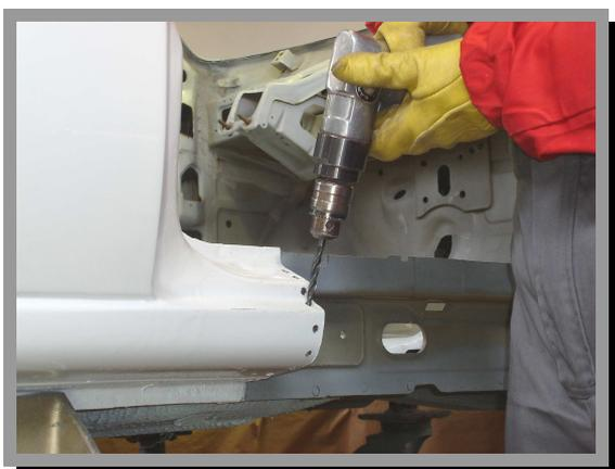
27. Practicar orificios en el estribo de la carrocería para la soldadura del refuerzo a tapón.
