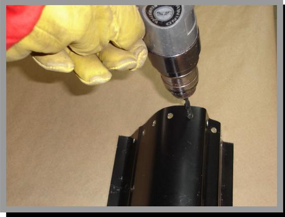
28. Practicar orificios en el recambio para la soldadura del refuerzo a tapón.
