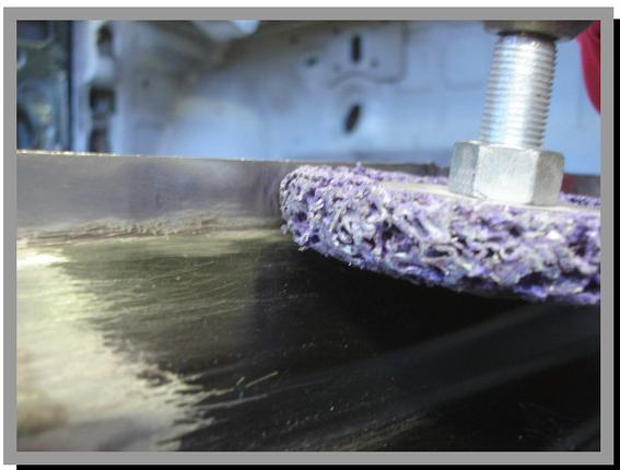
41. Eliminar la cataforesis de la zona de contacto de los electrodos –con un disco de nylon expandido o de acero trenzado– para soldar por puntos de resistencia.
