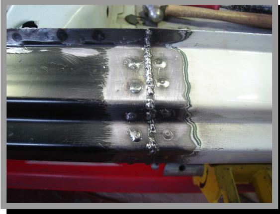
43. Acabar de soldar con soldadura MAG continua a pequeños intervalos para reducir el calor generado.
