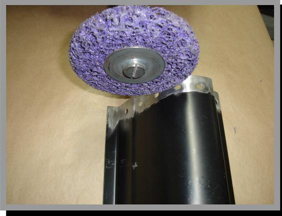
36. Eliminar la cataforesis de los bordes del recambio para facilitar la operación de soldadura a tope.
