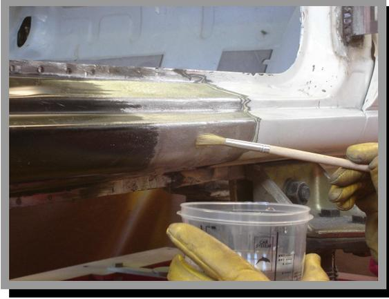
55. Eliminar los restos del líquido limpiador con un pasivador compuesto de ácido fosfórico diluido en agua.
