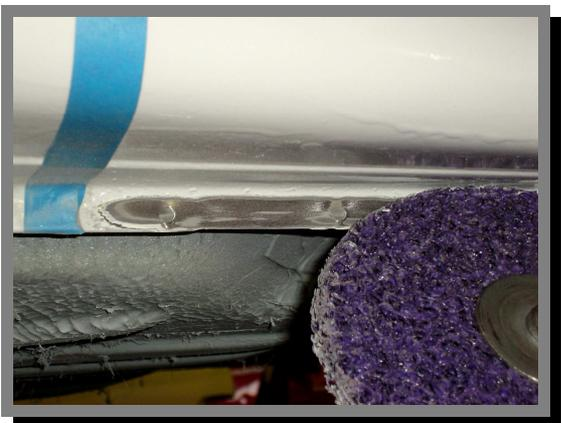
9. Realizar la misma operación en los puntos de la pestaña inferior con un disco de nylon expandido o de acero trenzado para eliminar el antigavilla.
