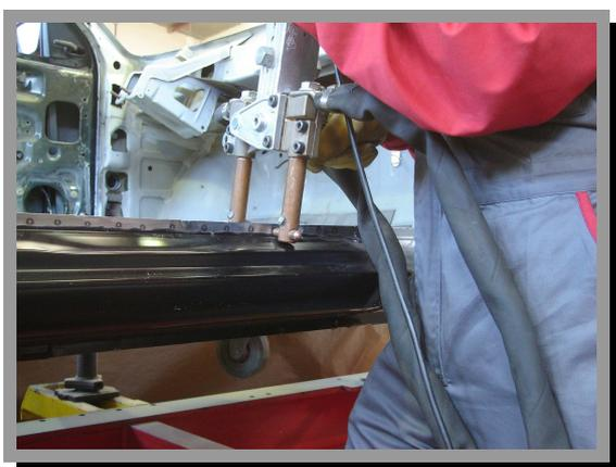
42. Soldar las pestañas por puntos de resistencia.
