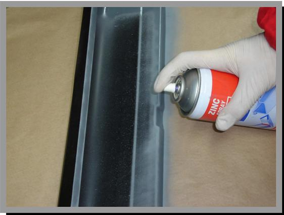
30. Aplicar imprimación electrosoldable de cinc en la cara interna de las pestañas y en las zonas en chapa viva.
