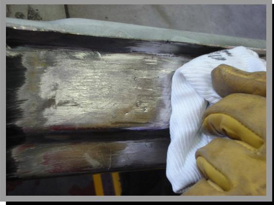
49. Pasar un trapo limpio, sin fibras ni hiladuras para extender el estaño.
