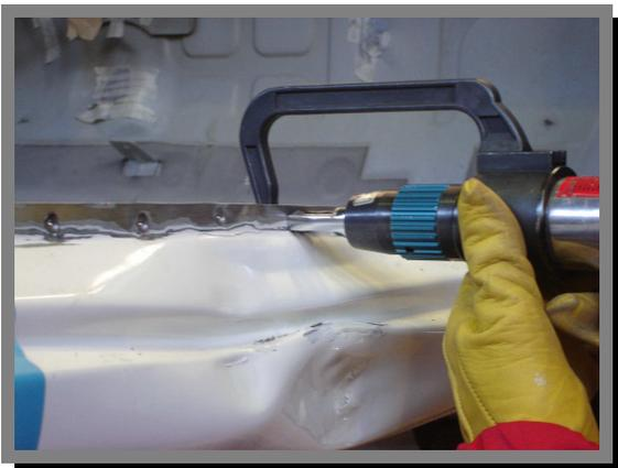
12. Eliminar los puntos de soldadura con despunteadora.
