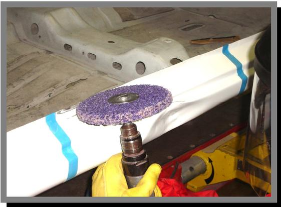
8. Eliminar con un disco de nylon expandido la pintura de la pestaña para dejar al descubierto los puntos de soldadura.
