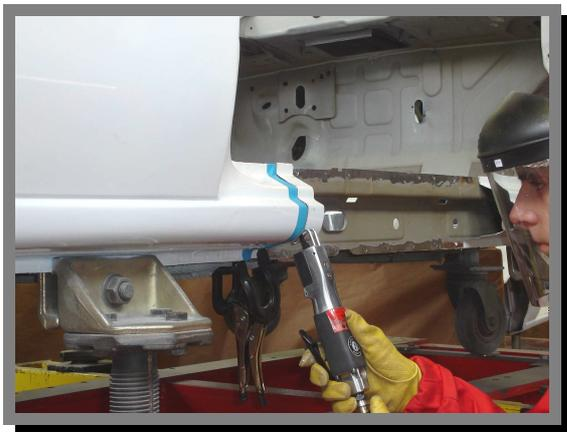
25. Cortar con la sierra de vaivén neumática el material sobrante del estribo de la carrocería.
