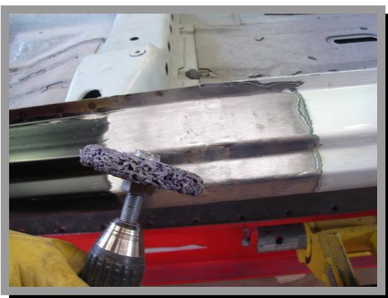
45. Limpiar la zona de la unión con un disco de nylon expandido y las hendiduras con un cepillo de alambre para favorecer el proceso.
