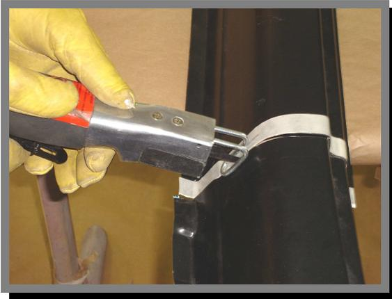
21. Realizar el corte definitivo con una sierra de vaivén neumática del recambio
