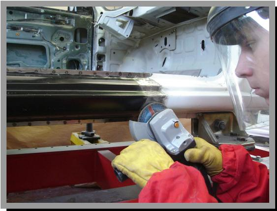
44. Repasar las soldaduras con la amoladora y disco de láminas lijadoras.
