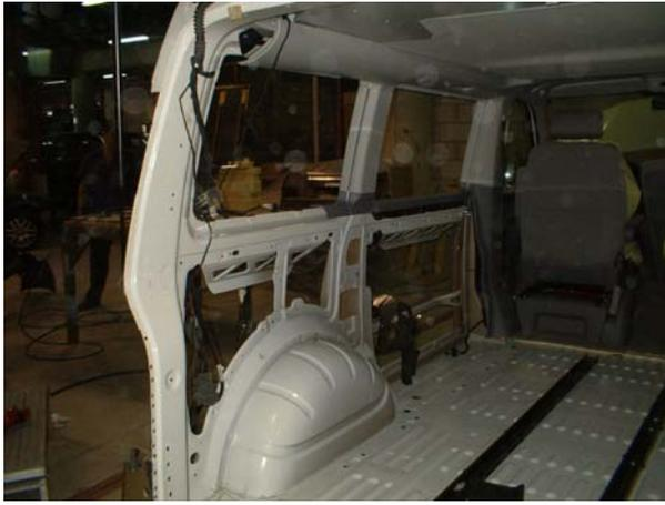
En esta imagen se ve el interior con toda la aleta desmontada y todos los accesorios de tapizado extraídos para luego soldar la aleta nueva.
