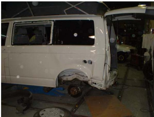
Antes de comenzar con la reparación debemos desmontar todos los elementos externos e internos que nos dificultan el trabajo. En esta imagen observamos la furgoneta ya fijada en una bancada de tipo tijera. Con los elementos externos quitados tenemos una imagen mas clara de los daños ocasionados.
