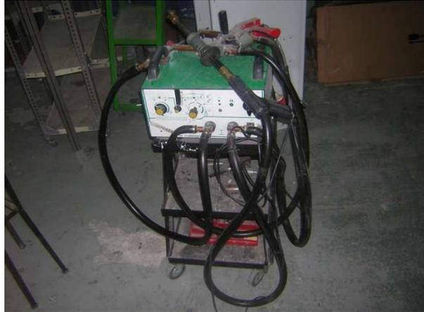
Estos equipos nos permiten la extracción de abolladuras, de zonas sin acceso, pero requieren la eliminación de la pintura para su aplicación.
