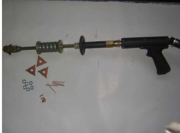
Se usa para retraer la abolladura por medio del acoplamiento del martillo de inercia sobre los elementos soldados como arandelas, clavos, etc. Está provisto de un eje con una masa de inercia que se desliza con recorrido determinado. En uno de los lados del eje tiene una parte roscada en la que se acoplan los útiles para soldar clavos, arandelas, etc., y los útiles para agarrar estos elementos. Y en el otro extremo se acopla la pistola para realizar la soldadura.
