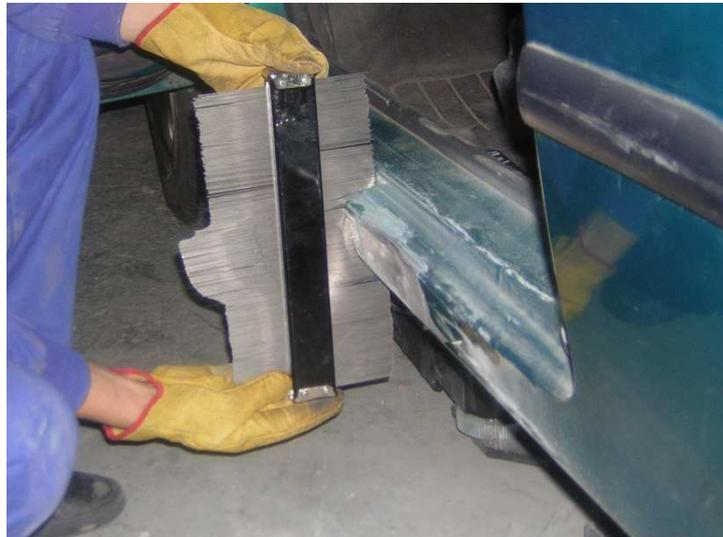
Nos permite comparar una zona que no tiene deformación con la zona que estamos reparando.
