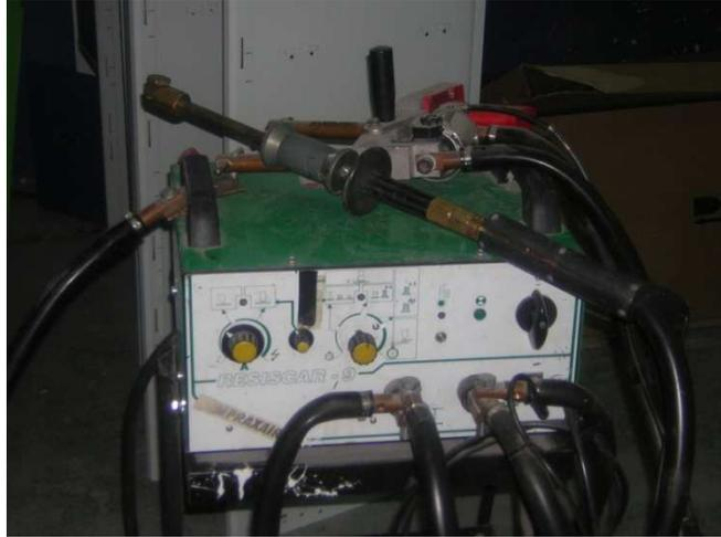
Estos equipos están diseñados para soldar diferentes elementos como clavos, arandelas, etc., donde se ha producido el golpe, y con el martillo de inercia traer la zona hundida hasta conseguir igualarlo lo más posible a la original.
