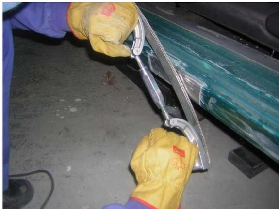
Nos permiten limar el estaño-plomo que utilizamos como material de relleno.
