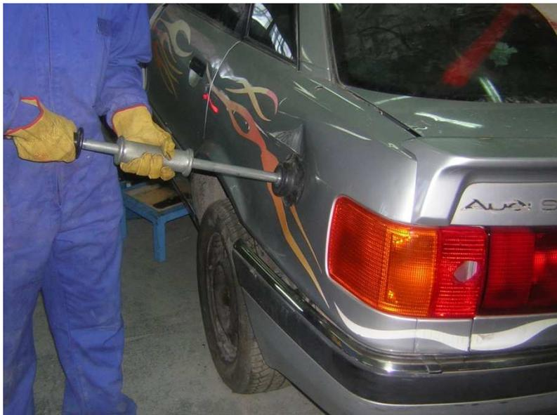
La superficie de contacto tiene un eje hueco donde se crea un vacío para que adhiera la ventosa, este eje está comunicado con el mango de la herramienta donde se encuentra la entrada de aire a presión, un regulador de aire y unos orificios de salida de aire.
